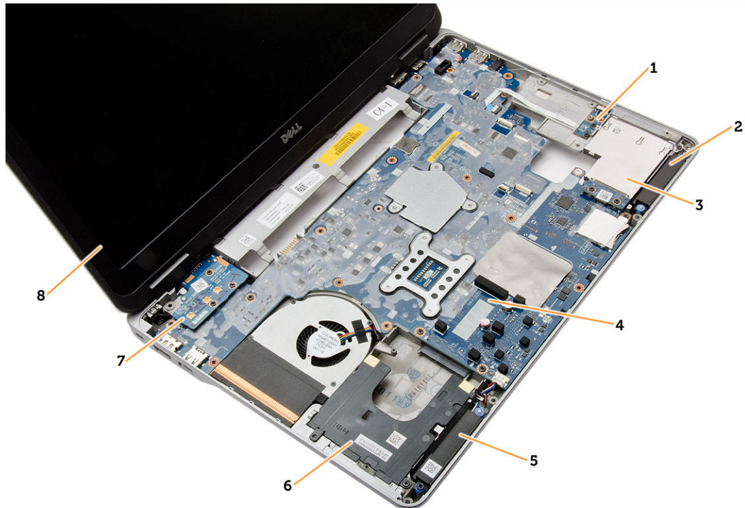
Figur 2. Sett ovenfra — Tastatur og håndleddstøtte fjernet
